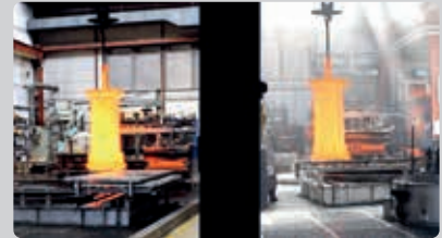
Vergleich des Flammverhaltens Universal-Hochleistungshärteöl THERMISOL QH 35 MC (rechts im Video)
